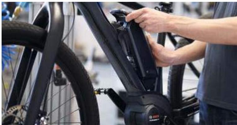
**PowerTube** – Avec la fonction confort, lors du déverrouillage, la PowerTube se déplace sur environ deux centimètres pour une préhension intuitive. Un mécanisme de sécurité empêche par ailleurs la chute de la batterie, qui est également protégée par le cadre.
