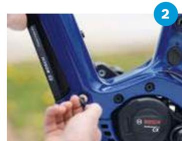
Avec le déverrouillage de la batterie au moyen d'une clé (en fonction du fabricant), la batterie tombe dans la protection de retenue
