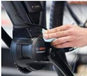
**Nettoyage et entretien** – Pour le nettoyage de la batterie, utilisez un chiffon humide. Nettoyez et lubrifiez légèrement les connecteurs de la batterie de temps à autre. Retirez la batterie avant de nettoyer votre VAE. Pour protéger les composants électroniques, ne nettoyez pas les batteries avec un jet d'eau direct ou à haute pression.
